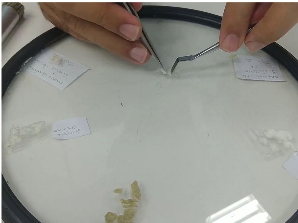
Figura 13 – Preparação da polpa de papel Canson Ingres e Hahnemühle para obturação mecânica.
