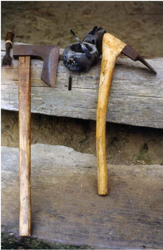
Figura 27 – Ferramentas de corte e acabamento. Da esquerda para a direita observamos o formão, machadinha utilizada para corte e entalhe, o sumitsubo e a enxó. Fotografia do autor.
