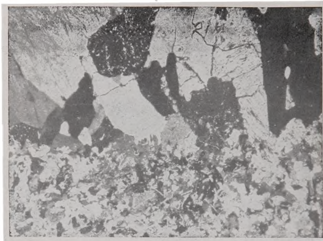
Fotomicrografia 7 — Nefelina-sienito bandeado. Contacto da banda clara com a escura. Os cristais maiores da banda clara estão dispostos perpendicularmente aos da banda escura. x 25. Nicóis+.
