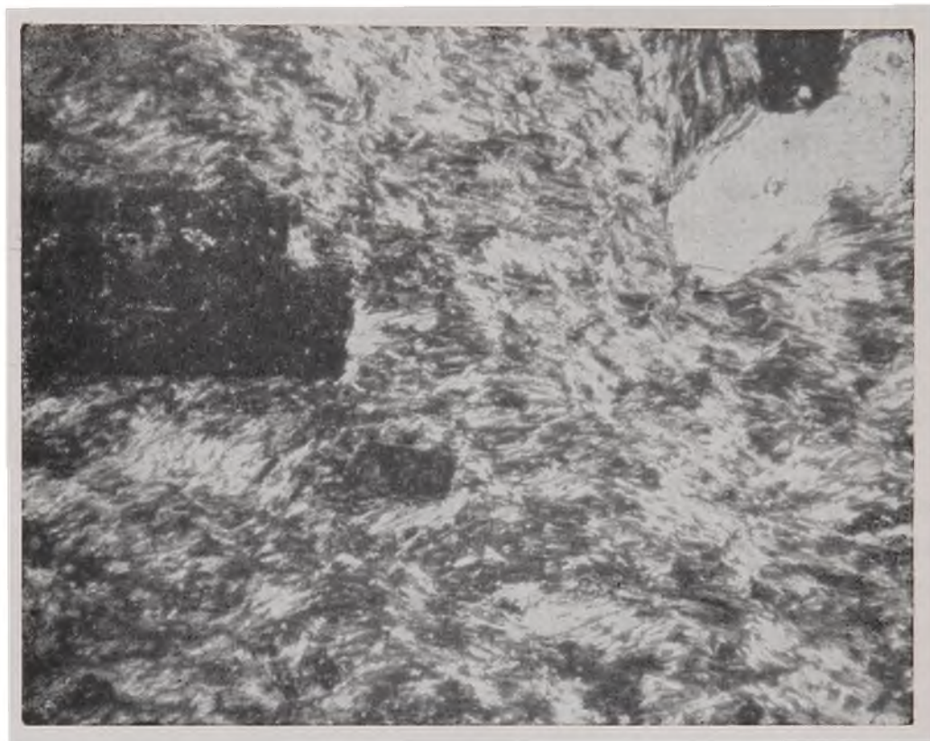
Fotomicrografia 12 — Estrutura fluidal em brecha magmática. x 25. Nicóis+.
