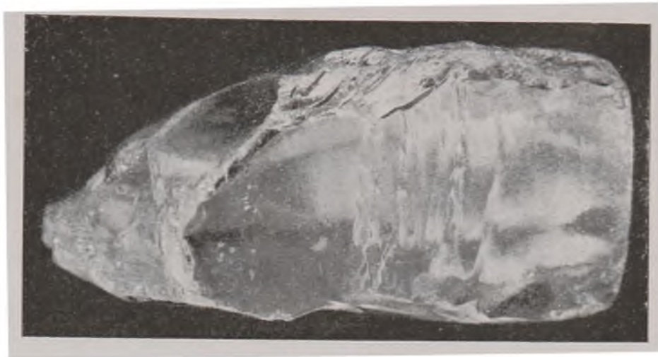
FIG. 10 Fotografia da superfície de clivagem Aumento 1,6 x (DIAMANTE PRESIDENTE VARGAS)
