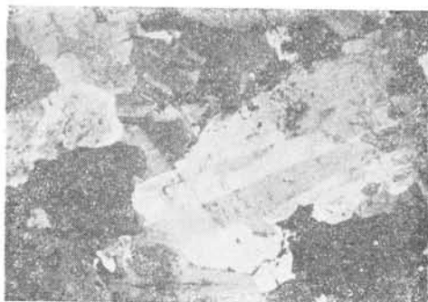
Fotomicrografia 7 — Granodiorito. Estrada d'Oeste ao norte de Quitaúna, T2-39. Nicóis a 45.º 10x. Textura hipidiomórfica granular. O quartzo, límpido e intersticial, mostra alguma deformação. Plagioclásio ripiforme, sericitizado zonado e com geminação complexa.
