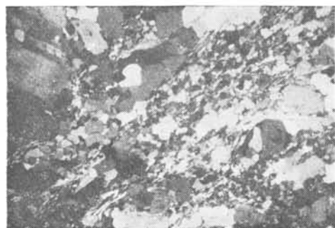
Fotomicrografia 19 — Gnaise ademelítico. Aracaré. F11-1. Nicóis cruzados. 12x. Quartzo concentrado em agregados pavimentosos de gran grossa, separados por mica, feldspatos e quartzo microgranulados e cristais maiores de feldspatos arredondados.
