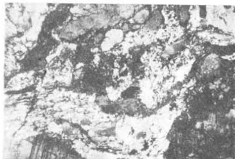
Fotomicrografia 25 — Gnaise milonítico. Entre Carapicuíba e Embu. T2-36b. Nicóis paralelos. 12x. Porfiroclastos de feldspatos e alguma biotita e ferro-hastingsita imersos em massa fina de rocha moída.
