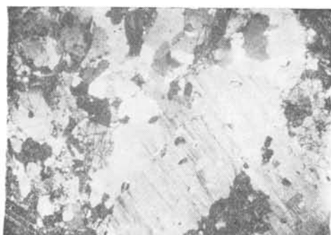
Fotomicrografia 17 — Gnaise granodiorítico. U5-75. Nicóis cruzados. 10x. Textura granoblástica. Quartzo segregado em agregado recristalizado (lado superior), feldspato e biotita com alguma evidência de milonitização à esquerda e grande cristal de microclínio (à direita em baixo) com inclusões e aparentemente substituindo plagioclásio no centro.
