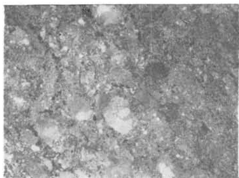
Fotomicrografia 1 — Metagrauwaque. Jaraguá. F7-117. Nicóis a 45.º 16x. Textura blastopsamítica. Grãos clásticos de quartzo, feldspato e agregados algo deformados em matriz sericitica xistosa.
