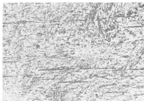
Fotomicrografia 29 — Inclusões de sillimanita em muscovita. Vila Tanque. U5-55b. Nicóis paralelos. 87x. Alguilhas de sillimanita suborientada se dispõem em direções transversais à clivagem (horizontal) da muscovita.
