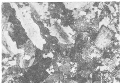
Fotomicrografia 21. Epidiorito. Penhinha. T6-65b. Nicóis a 45.º 27x. Textura blastofítica. Como a anterior, mais hornblenda indistinguível de biotita.
