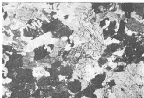
Fotomicrografia 24 — Anfibolito. Sul de Ipava. Nicóis paralelos. 13x. Plagioclásio e hornblenda em textura granoblástica.
