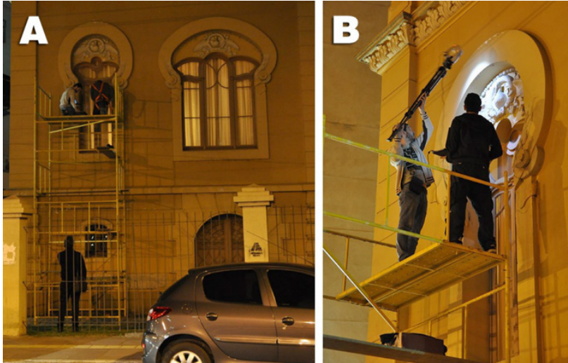
Figura 5: Janela do Observatório Astronômico da UFRGS. Digitalização com andaime (A) e extensor (B)
