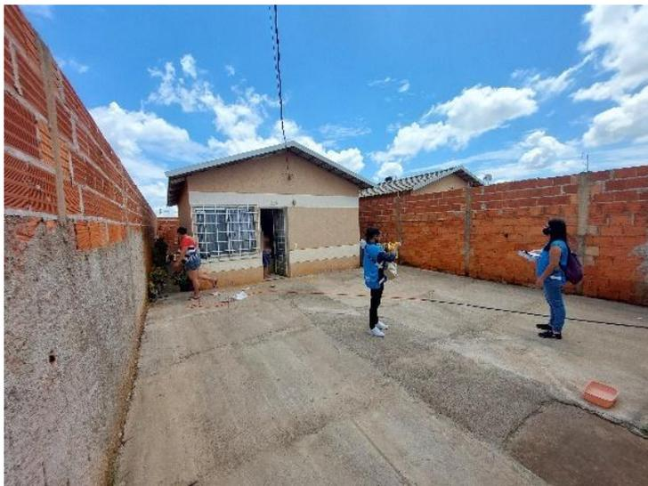
**Figura 7.** Exemplo de HIS no 2A4, onde é possível observar uso de telhas em concreto e implantação do embrião isolado no lote (frente).
