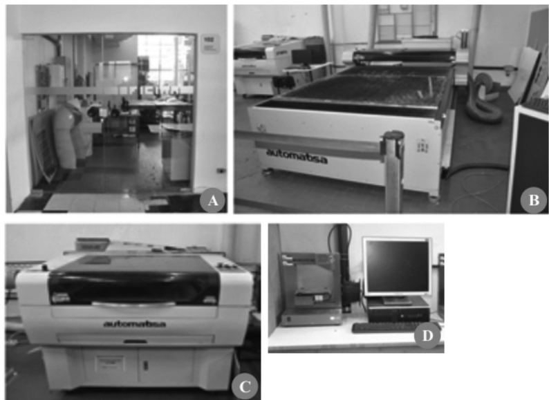
Figura 1. Porta de entrada da oficina (Figura 1A), máquina de corte a laser 200 watts (Figura 1B), e máquina de corte a laser 60 watts (Figura 1C) e impressoras 3D (Figura 1D).
