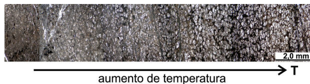
Figura 9. Variação textural na escala microscópica, evidenciando aumento do efeito termal de uma extremidade para outra da seção delgada. Fotomosaico de parte da amostra J122 sob polarizadores paralelos.
