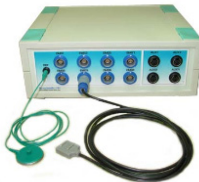
Figura 1: Aparelho Eletromiógrafo Portátil MyoSystem-I PS4
