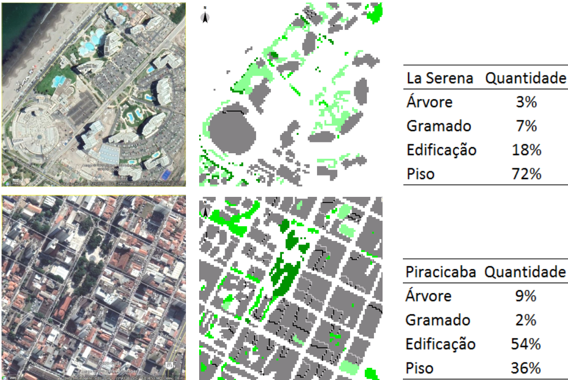
FIGURA 2: Modelo microclimático dos recortes em La Serena/Chile e Piracicaba/Brasil, sendo os edifícios em cinza, os pisos em branco e a vegetação em verde; quanto mais intenso o verde, maior a densidade foliar da vegetação. Fonte:Produção dos autores.
