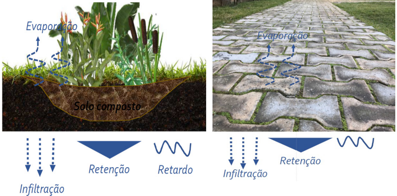
FIGURA 1. Exemplos de Células de bioretenção, Jardim de Chuva e Pavimento Permeável, e seus processos hidrológicos. Fontes: Dos autores.
