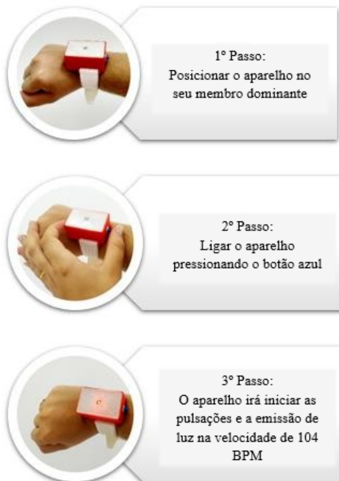
Figura 3 Passo a passo da utilização do aparelho
